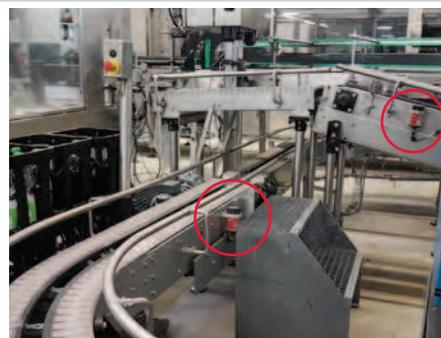
Lubricación de cadena en el transporte de cajas tras la empaquetadora y el control de cajas llenas
