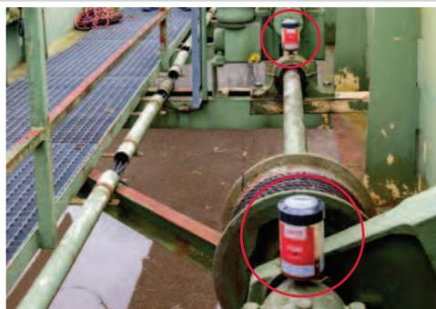
Lubricación de rodamientos en el separador
