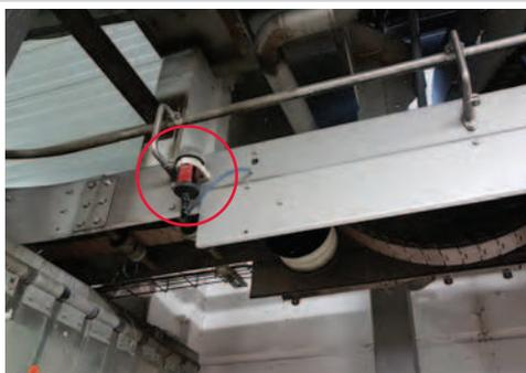
Lubricación de cadena en el transporte de cajas hacia el dispositivo de expulsión de cajas
