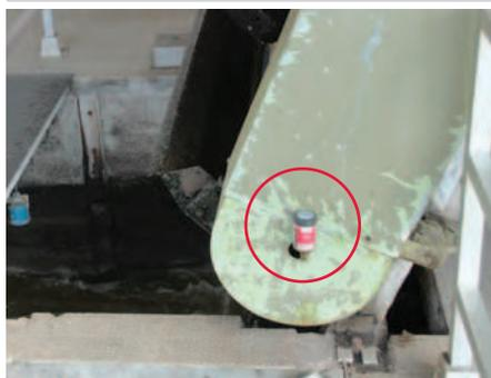
Lubricación de rodamientos en el cribado grueso
