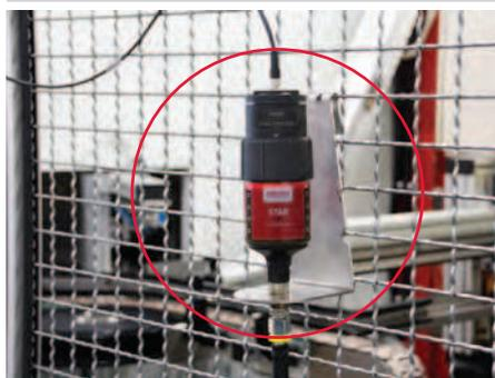
Lubricación automática de una guía de deslizamiento
