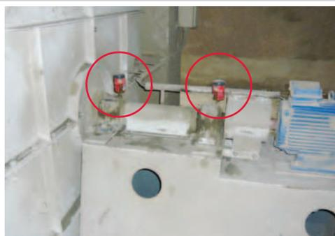
Lubricación del cojinete de soporte de un eje del ventilador
