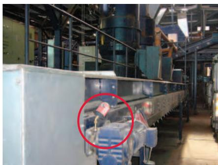
Lubricación del cojinete de brida de una cinta transportadora
