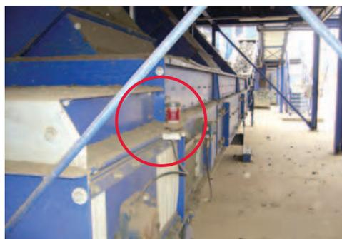
Lubricación del cojinete de brida de una cinta transportadora
