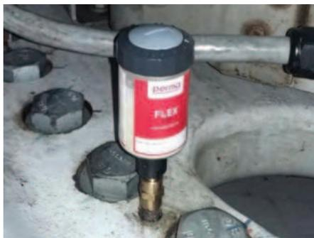
Lubricación del engranaje azimut
