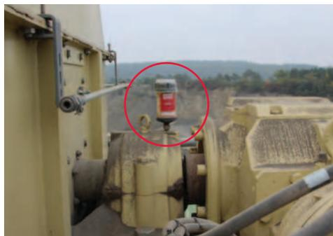
Lubricación del rodamiento en el elevador térmico
