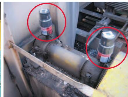
Lubricación de los cojinetes del eje del ventilador
