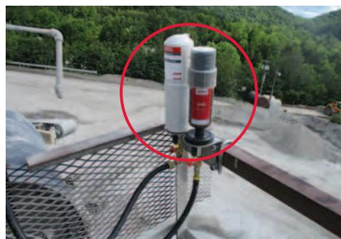
Lubricación del cojinete de soporte de una cinta transportadora
