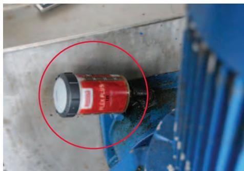
Lubricación del cojinete de una bomba
